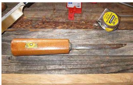
Splitting tool ricavato da una vecchia scorbina molata a dovere.
