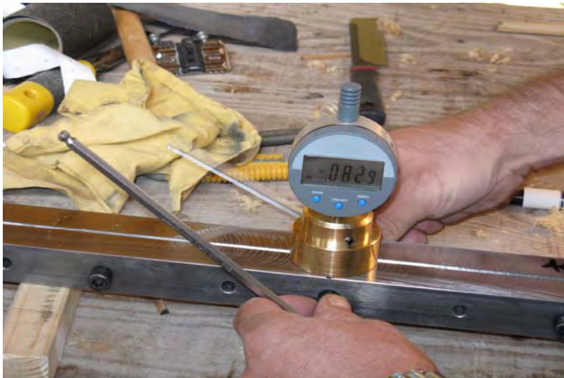
Settaggio PF. Si regola la profondità della PF agendo sulle viti che stringono e su quelle che spingono.
