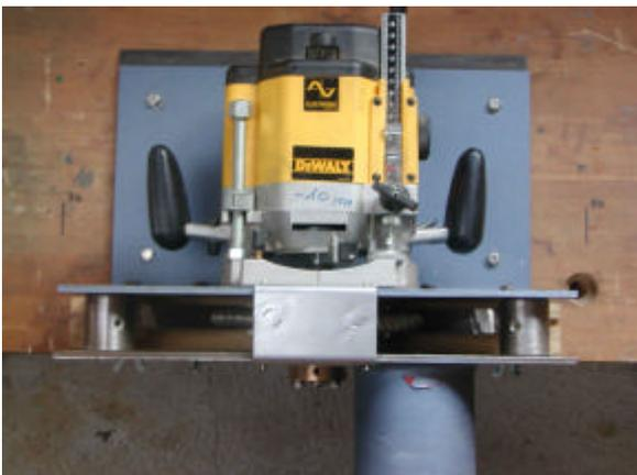
La fresatrice portatile è una DeWALT da 1.100 W che ruota alla velocità minima ( 8.000 giri/m ), con pinza per perni da 12 mm. Essa è rigidamente avvitata sulla branca verticale della struttura per mezzo della base d' appoggio in dotazione.
