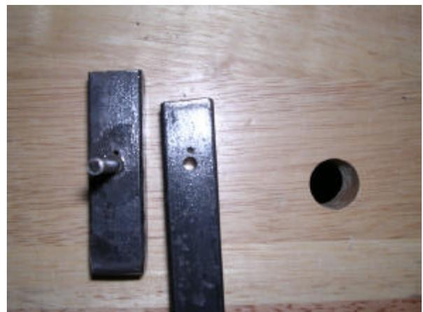
Realizzati tutti e 4 gli attrezzi siamo pronti: si inserisce la parte di attrezzo col codolo in morsa e dopo avere infilato uno spezzone di filo di acciaio nel foro di 1mm si inserisce nella stessa maniera il secondo pezzo e lo si ruota su se stesso formando così la serpentina, naturalmente quando si estrae e' un po' storta e necessita di un'aggiustata con le pinze.
