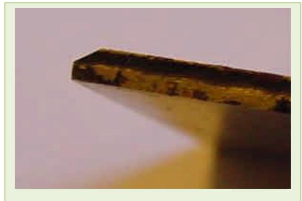
La lama è quella originale Stanley. Io uso intestare 90 gradi. Si possono usare angoli maggiori o minori, c'è ampia possibilità di sperimentazione. Non è necessaria grande precisione dell'angolo.
