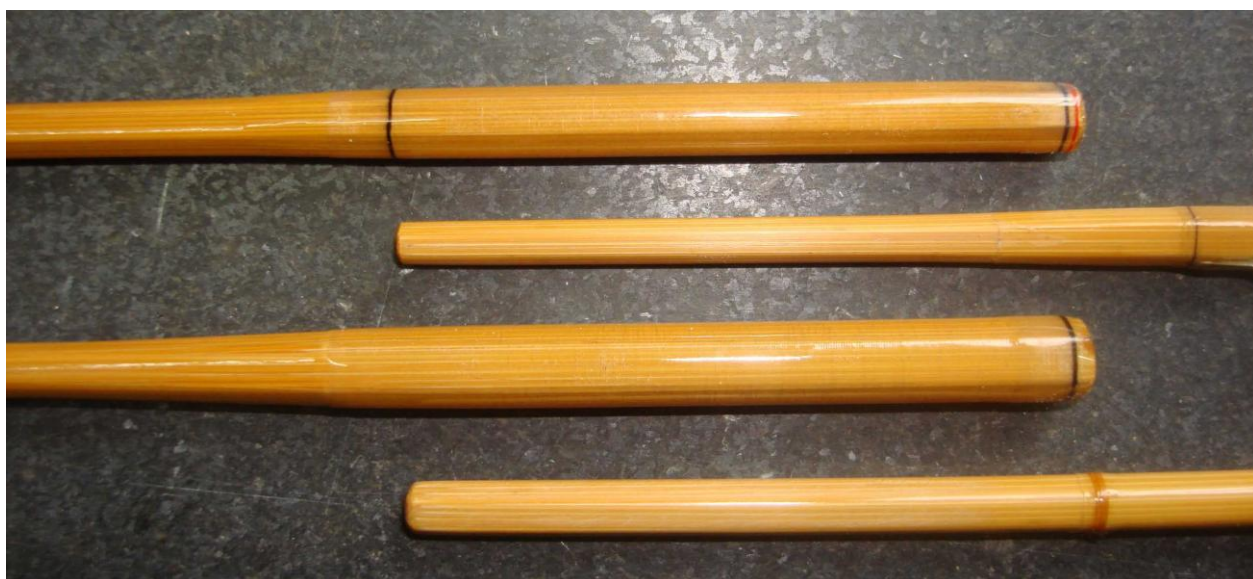
Comparazione tra un innesto streamlined (sopra) e normale (sotto) Realizzazione e fotografia di Philipp Sicher
