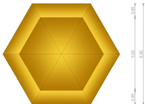
SEZIONE TIPO DELLA GHIERA IN BAMBOO DA 5 mm
