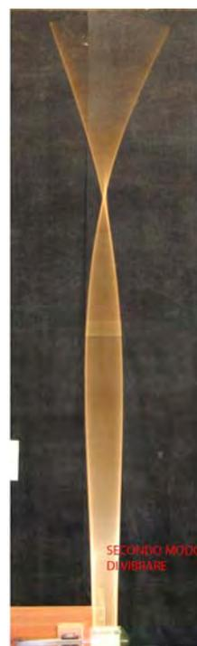
Ora se aumentiamo ancora la frequenza del movimento della mano, vedremo che la deformazione della canna diminuisce moltissimo, e contemporaneamente assume una forma diversa: nasce un flesso, ossia un fulcro a circa un terzo della lunghezza a partire dell'apicale, e vedremo anche che il movimento dell'apicale non è più in fase con quello della mano: quando la mano si muove in avanti, l'apicale si muove all'indietro.
