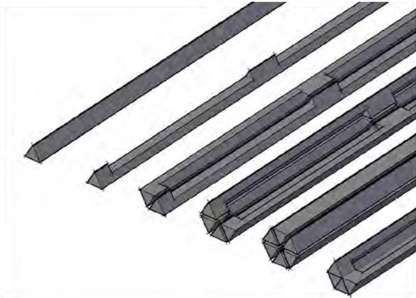
Tuttavia i tratti pieni sono piuttosto distanziati e di misura molto inferiore ai tratti pieni: in realtà i tratti pieni hanno la funzione prevalente di evitare l'ovalizzazione della sezione, così come fanno i diaframmi all'interno di un culmo di bamboo. Non si commette un errore sensibile trascurando la presenza dei tratti pieni, considerando cioè la sezione cava continua per tutta la lunghezza, come fosse una fluted.
