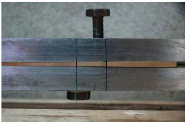
Le strip vengono piallate con cura rimuovendo poco materiale con un passaggio per lato per volta. In questo modo otteniamo un taper regolare su entrambe le facce dello strip. Quando le strip saranno piallate si passa alla cavature .
