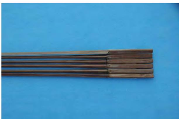
Il prossimo passo è l'assemblaggio preliminare per vedere se ci sono linee di colla o se una strip non è piallata bene .
