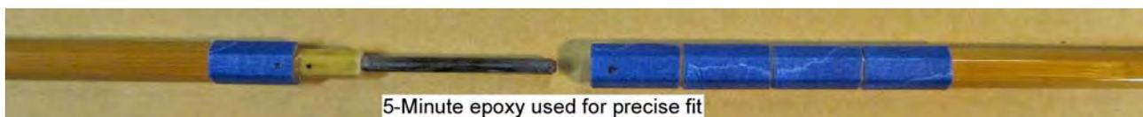
Figura 5. Preparazione per l'inserimento dello spigot nella cavità
