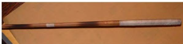
Una volta completata la piallatura le sei strips sono unite e fissate col del nastro adesivo di carta.
