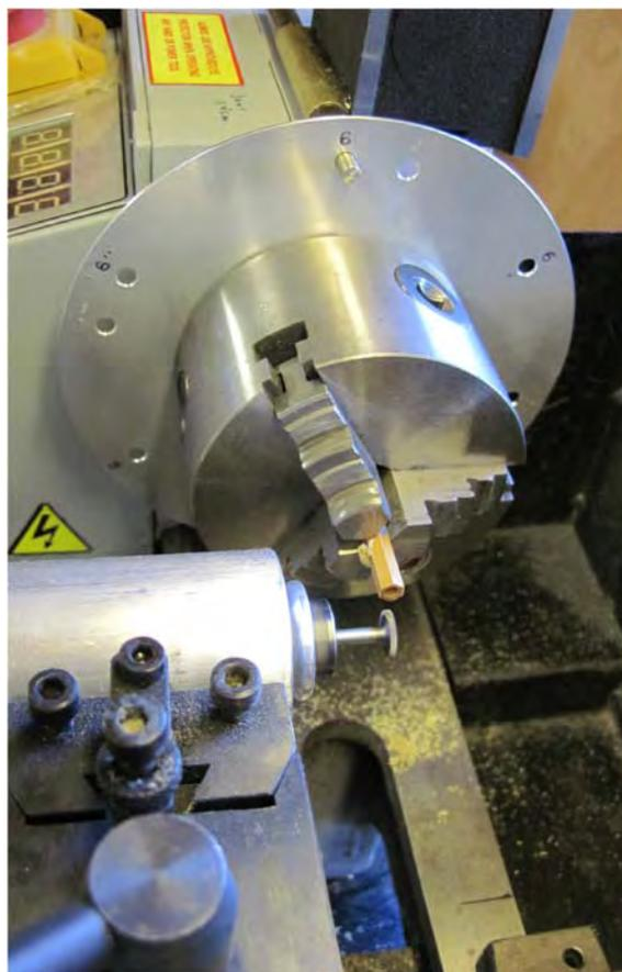
Dopo l'indurimento, è necessario rimuovere l'eccesso nel bicchierino in modo tale che lo spigot possa scivolare facilmente al suo posto. La parte tonda del bicchiere si può pulire con punte da trapano della misura appropriata. Per ripulire il manicotto esagonale, vanno bene le limette quadre da orologiaio con la punta spezzata e molata a forma di scalpello (vedi immagine).
