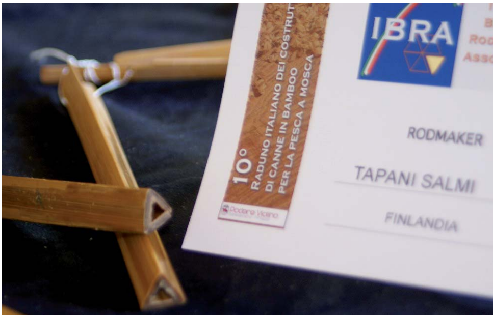
Hollow Triangular Rods di Tapani Salmi, Finlandia
