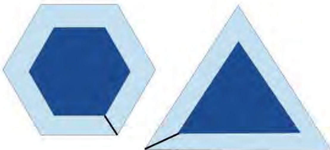
FIGURA 3 . Canna esagonale e triangolare come nella figura 1 svuotate per il 50% della massa. La massa di entrambe le canne è uguale, il Momento di Inerzia della sezione esagonale è il 36% maggiore della triangolare. Le linee di colla sono evidenziate.
