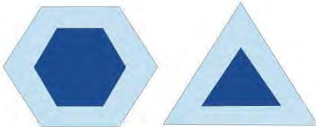
FIGURA 2 . Canna esagonale e triangolare con uguale spessore di parete. Il Momento di Inerzia della esagonale è maggiore di quello della triangolare
