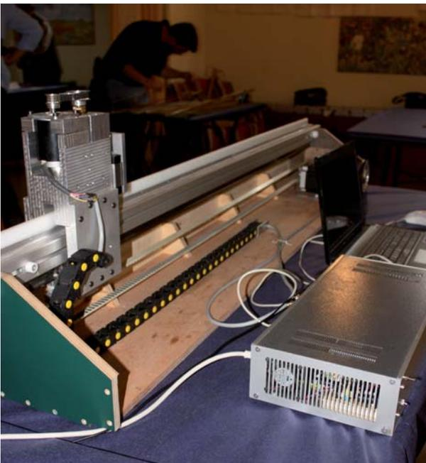
*Saverio Pandolfi ha esibito al raduno una macchina automatica a controllo numerico per la "piallatura" dei listelli a partire dalle coordinate del taper. Per il momento è un prototipo, ma sarà questo il futuro del rodmaking?*
