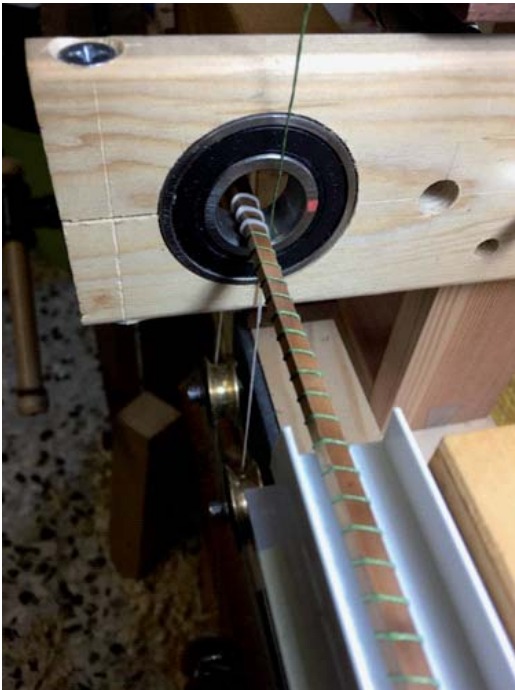
Fig. 2 - Vista frontale del cuscinetto a sfere.
