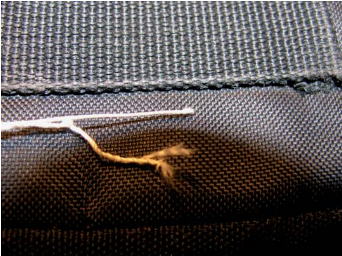
Fibre corte e lunghe nello stesso filato a pochi centimetri di distanza
