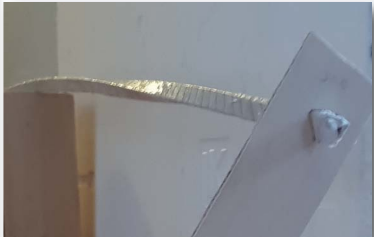
Figura 4 : Torsione della canna triangolare (qui con legatura a spirale)
