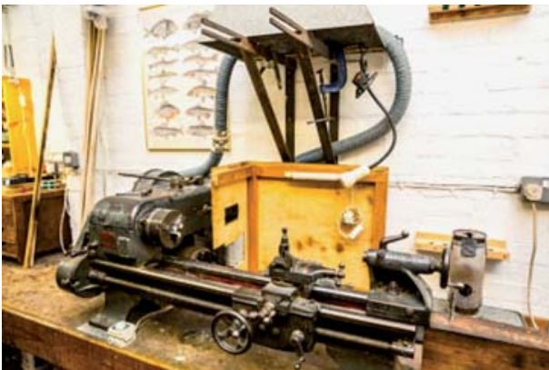
Il tornio Logan costruito prima del 1939 a Chicago che utilizziamo per tornire inserti per mulinello, tappi per ferrule e impugnature in sughero.
