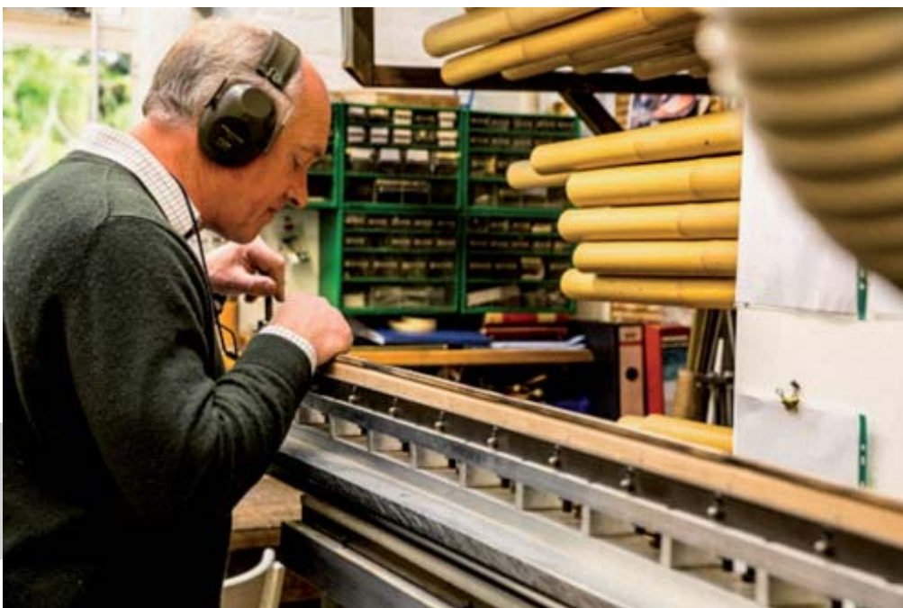
fissaggio delle strip sul carrello della milling machine
