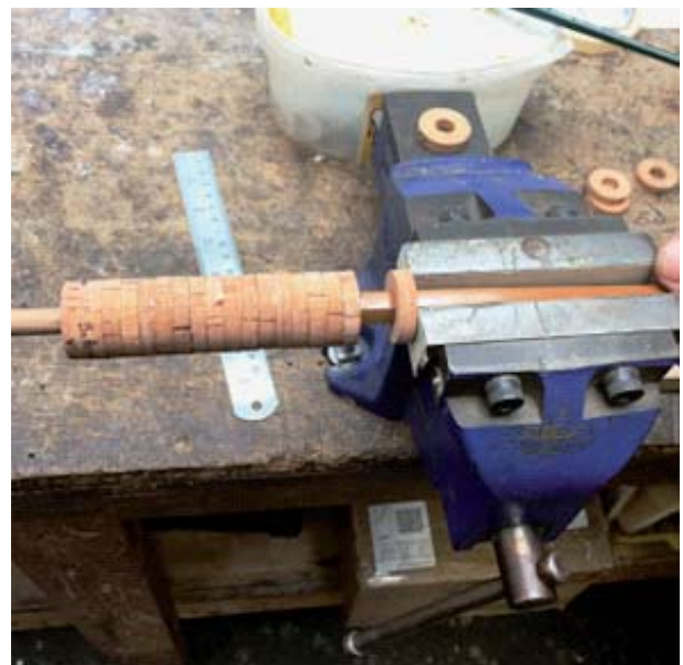
Rondelle di sughero portoghese appositamente selezionate della migliore qualità, nota come grado Flor, vengono incollate uno alla volta per formare l'impugnatura della canna
