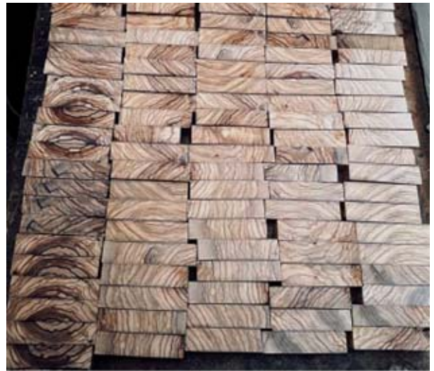
Billette di legno di ulivo toscano stagionate pronte per essere tornite e sagomate. Il legno d'ulivo, tagliato trasversalmente, è tutto ciò che usiamo. È incredibilmente duro, molto fiammato ed è una caratteristica delle nostre canne da mosca
