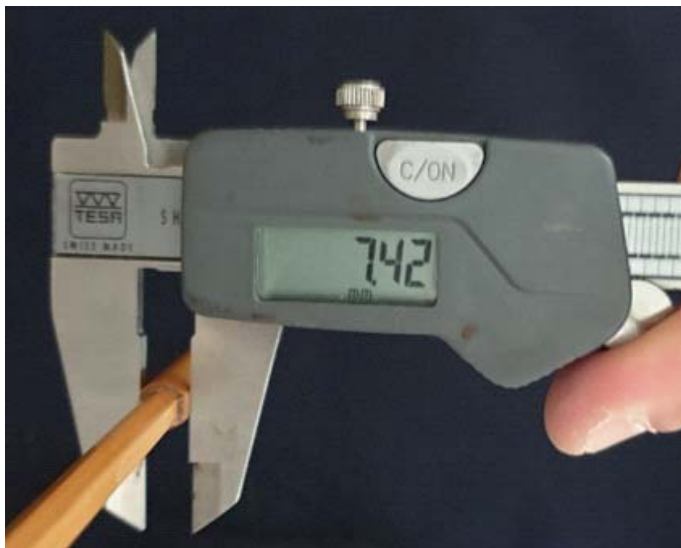
Misura larghezza femmina con maschio innestato
