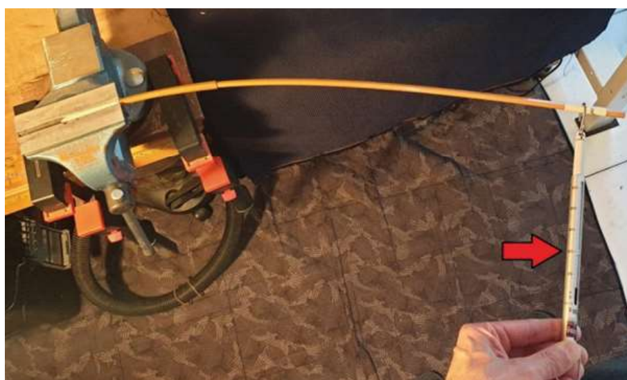
Prova di carico fino a 1kg (2.2lb) su innesto TBF campione
